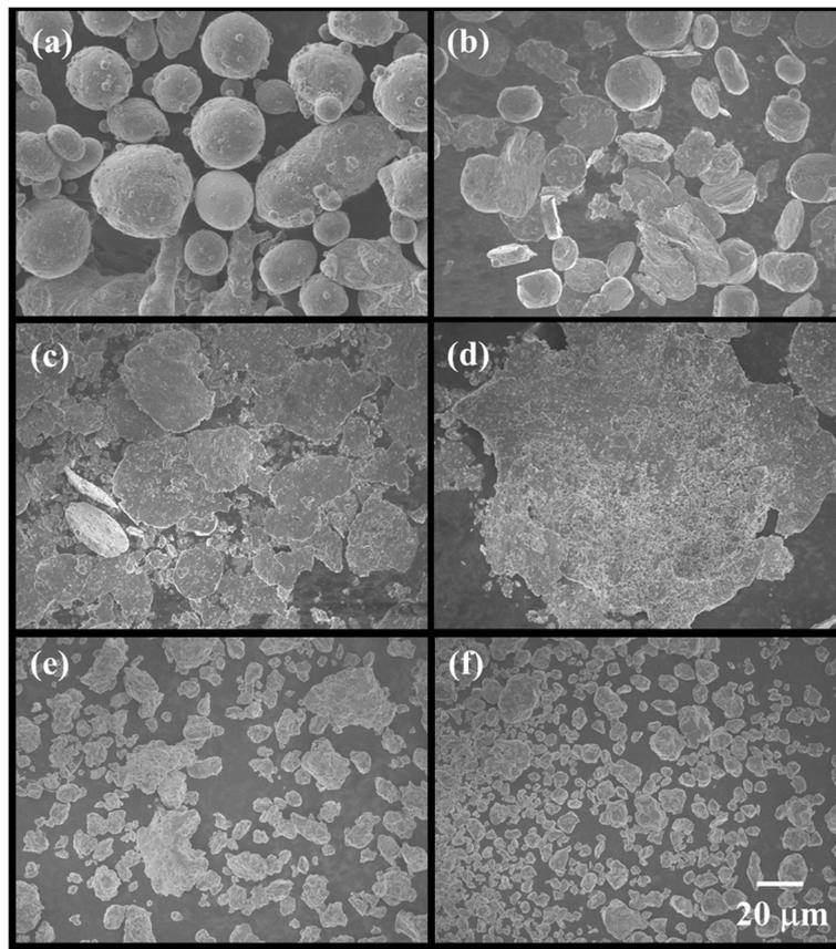
**Fig. 3** The SEM morphologies of the ball milled Al-GNSs composite powders at (a) 0 h, (b) 2 h, (c) 5 h, (d) 10 h, (e) 15 h and (f) 20 h
