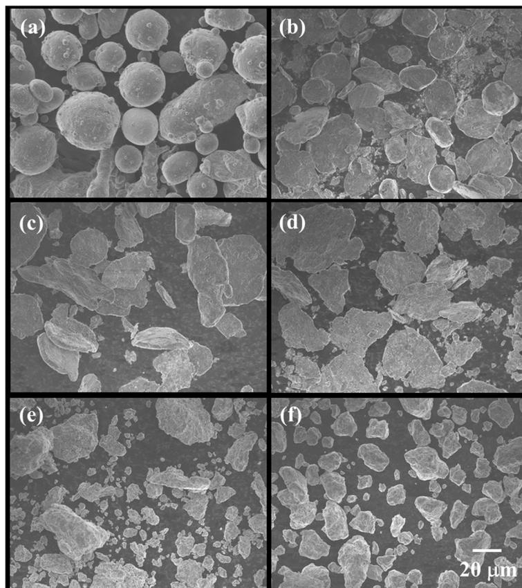
**Fig. 2** The SEM morphologies of the ball milled Al alloy powders at (a) 0 h, (b) 2 h, (c) 5 h, (d) 10 h, (e) 15 h and (f) 20 h
